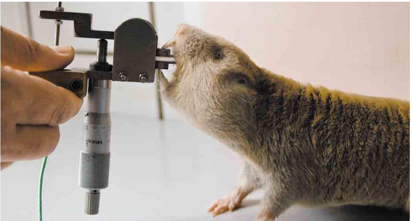
Abb. 12: Ein Riesengraumull soll zum Testen der Beißstärke auf das Metallstück am Vorderende des Gerätes beißen. Riesengraumulle haben die stärkste Beißstärke (bezogen auf das Körpergewicht) unter allen Säugetieren. A giant mole-rat is provoked to bite on a piece of metal connected to an electronic device which measures the bite force. Giant mole-rats have the strongest bite force among mammals (relative to the body weight). (Foto: Paul Van Daele)
